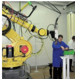
La plate-forme de soudage par laser de l'Institut Maupertuis permet aux industriels de tester de nouveaux procédés d'assemblage.
